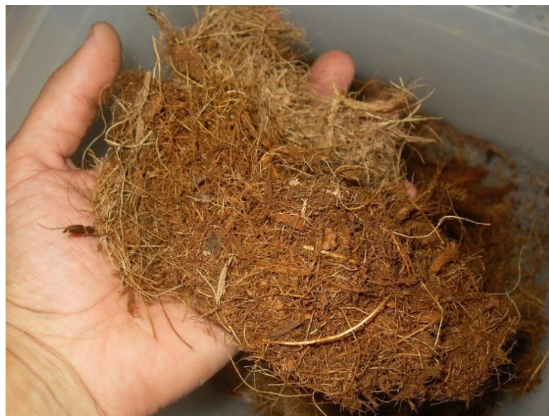
Figura 12, Fibra de coco para ensayos en probetas de hormigón
