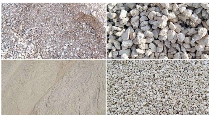
Figura 3, Agregados para el hormigón.
