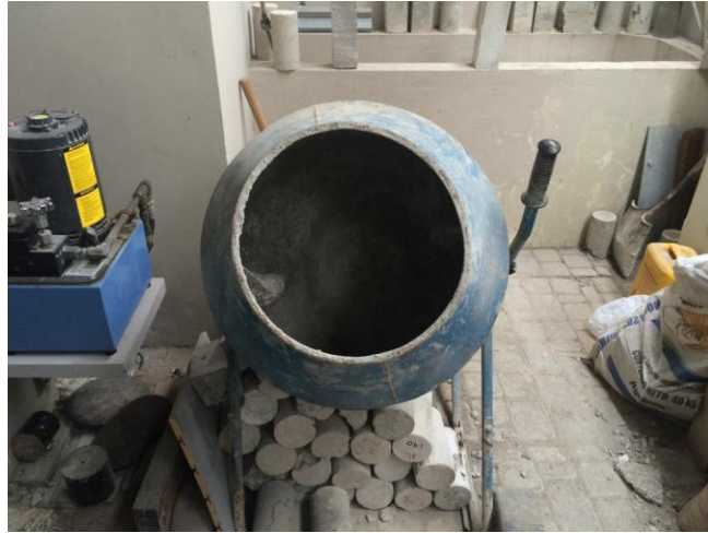
Figura 14, Concretera para realizar mezclas de agregados
