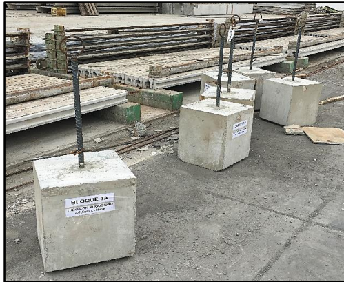
Figura 49. Foto de los especímenes en la planta de prefabricados Mavisa S.A. elaborados para los ensayos de extracción. Fuente del autor.
