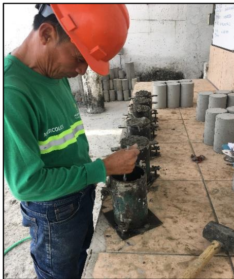
Figura 42. Obtención de testigos del hormigón de los bloques en cilindros. Fuente del autor.
