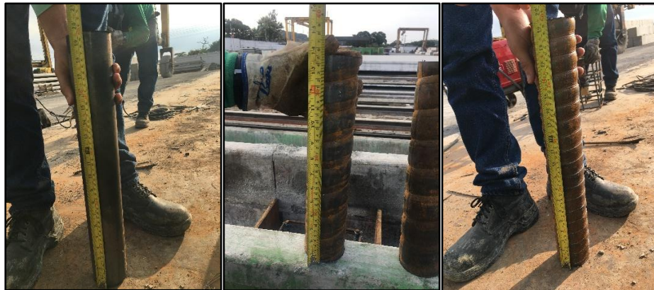
Figura 39. Tipos de ductos de acero a utilizar para el ensayo experimental. Fuente del autor.
