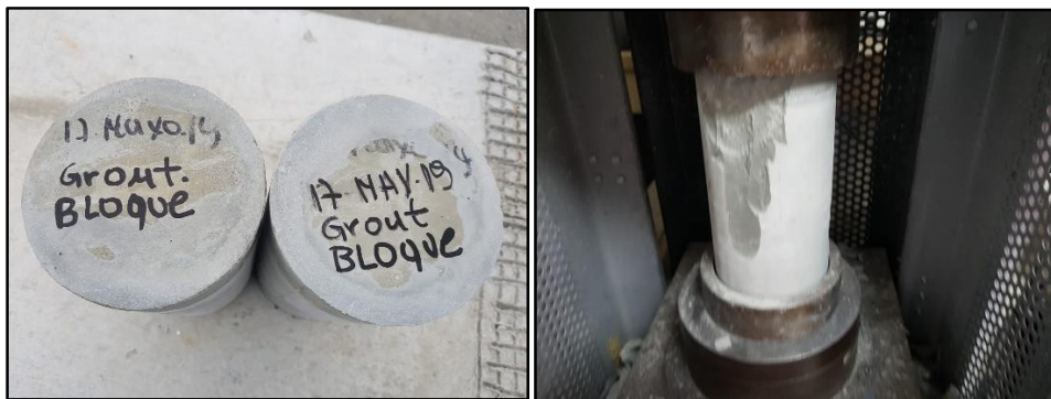
Figura 48. Rotura de cilindros de grout. Fuente del autor.
