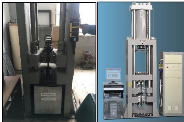
Figura 38. Máquina de ensayo a la tensión Controls C810/CZ. Fuente del autor y (Controls Group, 2015).
