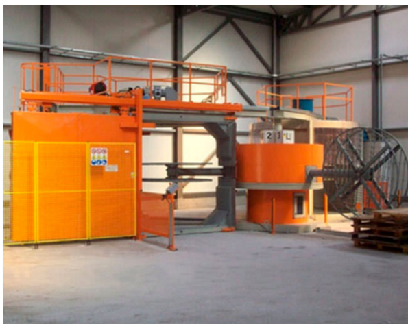
Figura 5. Máquina Rotomoldeadora donde se fabrican las tapas para tanques contenedores de agua Fuente: (Plastigama Wavin, 2019)
