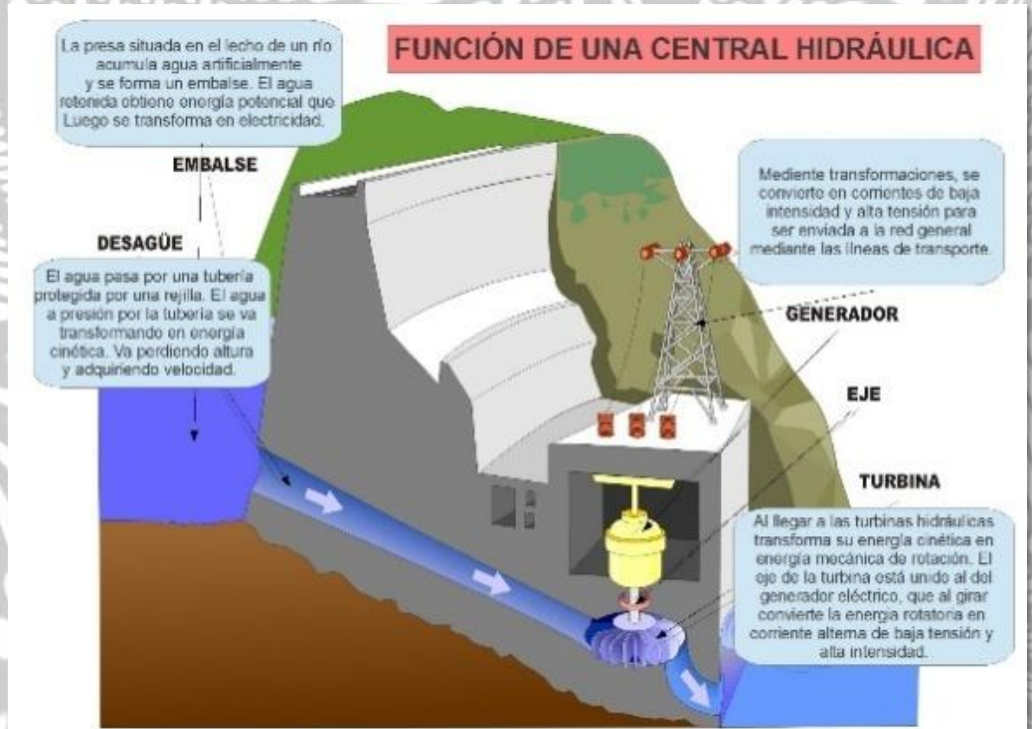
Imagen 23 diagrama hidroeléctrica Almanaque (ALMANAQUE, 2001).
