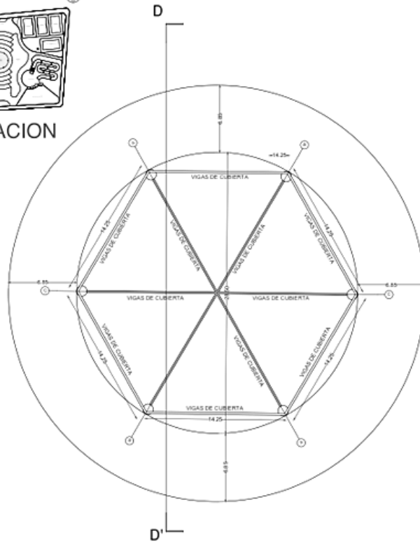
PERGOLA Y ESCENARIO VIGAS DE CUBIERTA ESCALA 1:100
