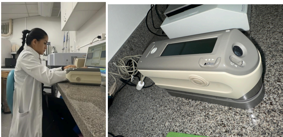
Figura 4. Toma de brillo, luminosidad de especímenes en espectrofotómetro.
