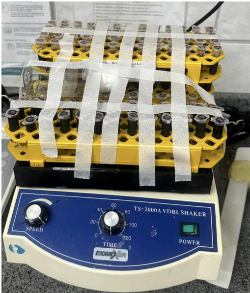
Figura 8. Equipo encargado de la agitación, simulando los movimientos bucales.
