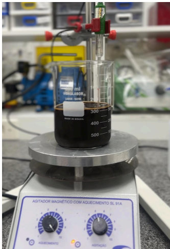
Figura 6. Creación de solución colorante y regulación de Ph.
