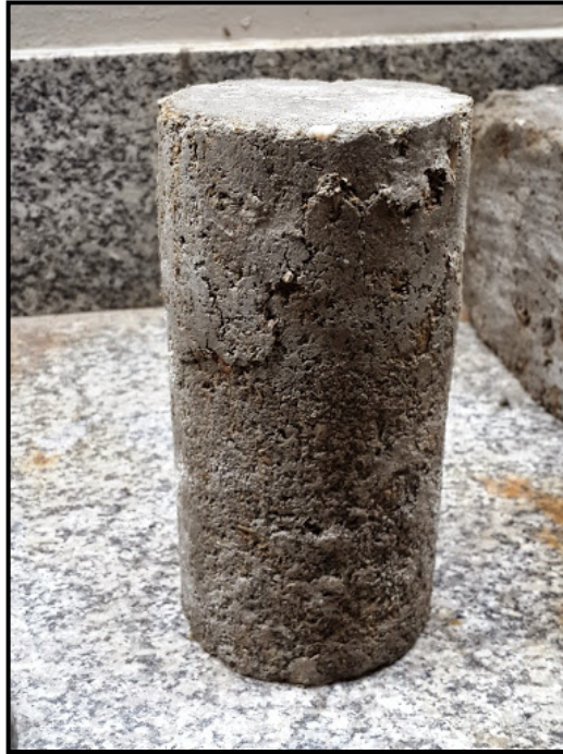
FALLA A LA COMPRESION
