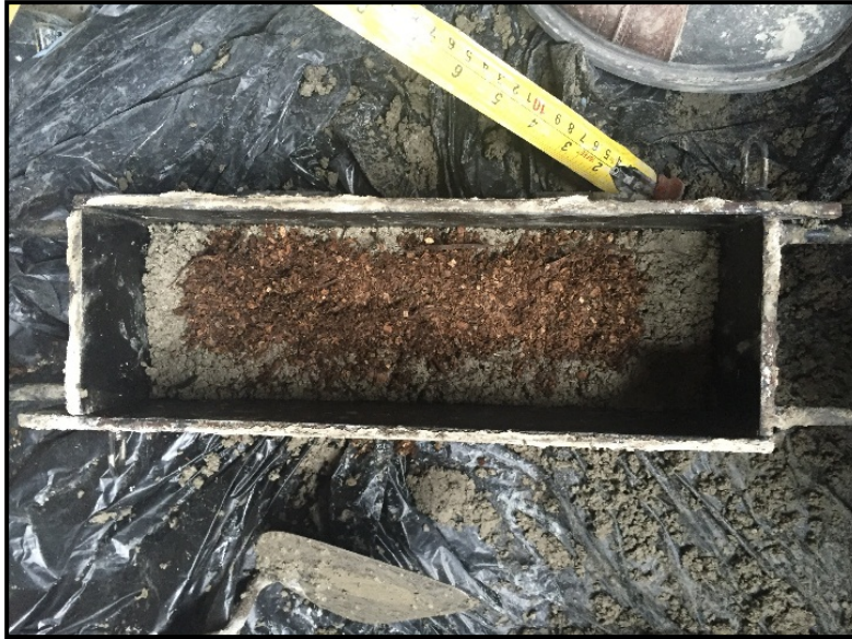
VIGUETA CON CAPA DE FIBRA DE REFUERZO
