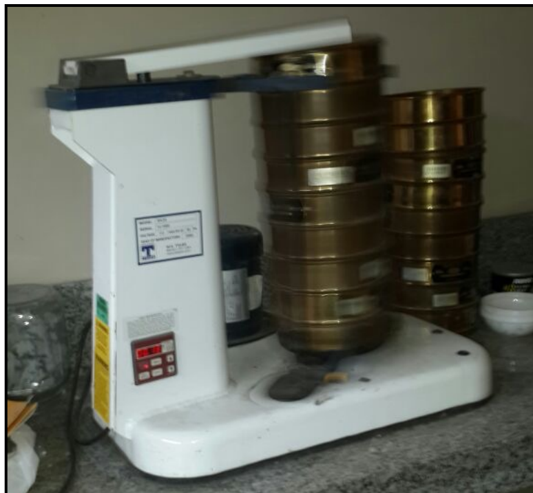
TAMIZADO DE ARENA HOMOGENIZADA
