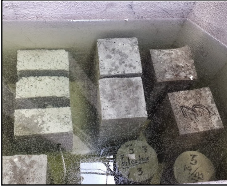
CURADO DE VIGAS Y CILINDROS
