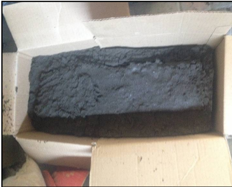
CURADO DE VIGAS EN ARENA SATURADA
