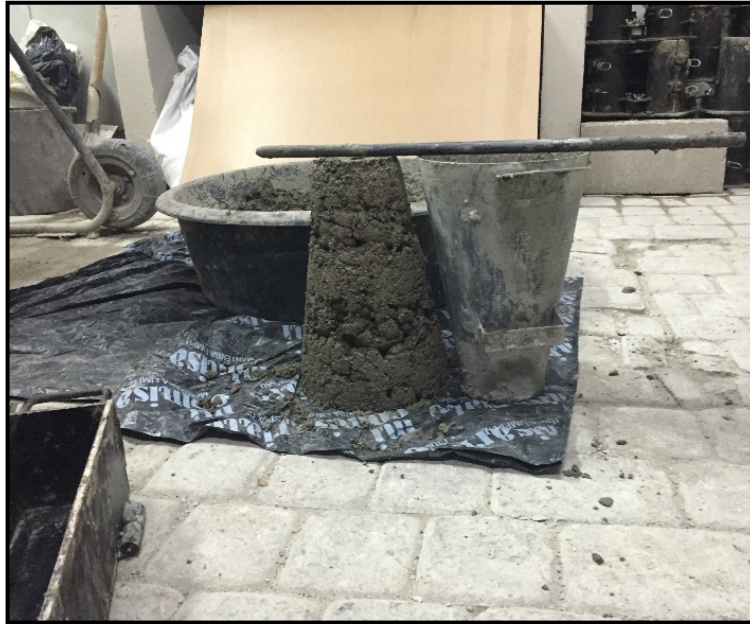
PRUEBA DE REVENIMIENTO
