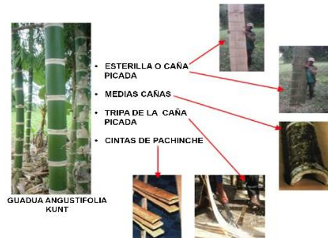
Figura 54. Transformación artesanal del Bambú.
