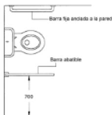
Barras de apoyo. Forma y disposición (Dimensiones en mm)
