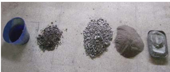
Foto 135, Proporciones de los componentes de la mezcla. Fuente: G. Pérez/S. Almeida
