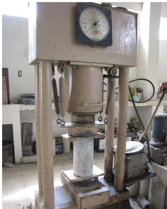
Foto 144, Cilindro en la máquina compresora Fuente: G. Pérez/S. Almeida
