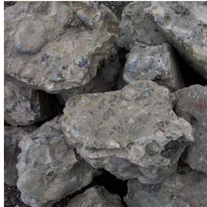
Foto 29, Hormigón pretriturado. Fuente: Hector Montoya, Investigación Reutilización de residuos de hormigón.
