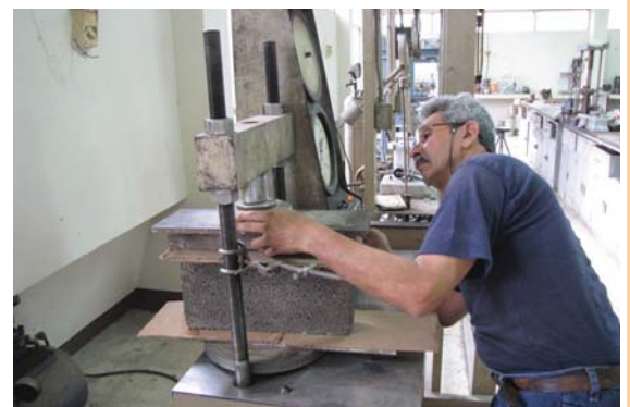
Foto 148, Bloque sometido a ensayo de resistencia a la compresión simple Fuente: G. Pérez/S. Almeida
