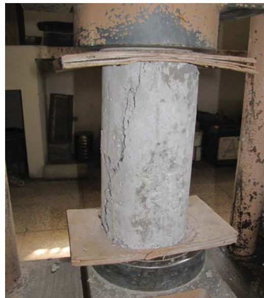
Foto 146, Rotura de uno de los cilindros Fuente: G. Pérez/S. Almeida
