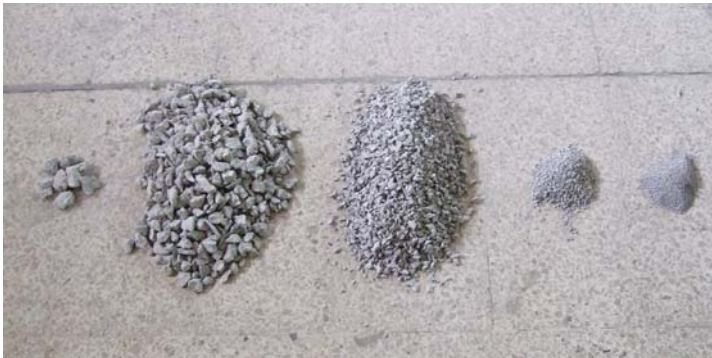
Foto 128, Granulometría obtenida de acuerdo a las normas ASTM después de la tamización Fuente: G. Pérez/S. Almeida
