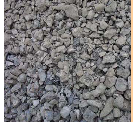
Foto 30, Hormigón triturado. Fuente: Hector Montoya, Investigación Reutilización de residuos de hormigón.
