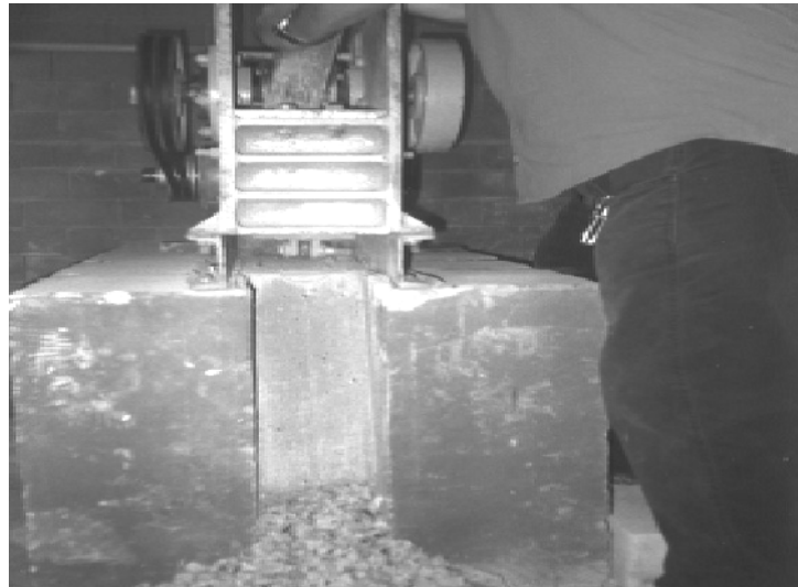
Foto 32, Triturado de piezas de hormigón para obtener áridos. Fuente: Revista Materiales de Construcción, 2007, España.
