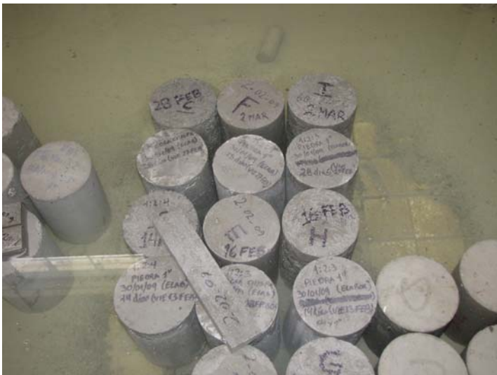
Foto 143, Curado de los cilindros de prueba dentro de la piscina Fuente: G. Pérez/S. Almeida
