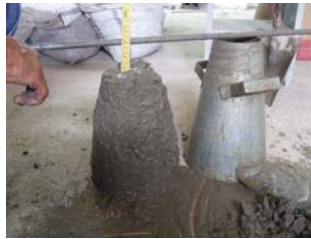
Foto 140 y 141, Medición de la prueba de revenimiento Fuente: G. Pérez/S. Almeida
