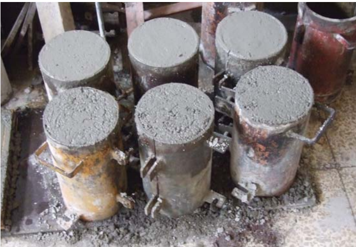
Foto 142, Vaciado de la mezcla en los cilindros de prueba Fuente: G. Pérez/S. Almeida
