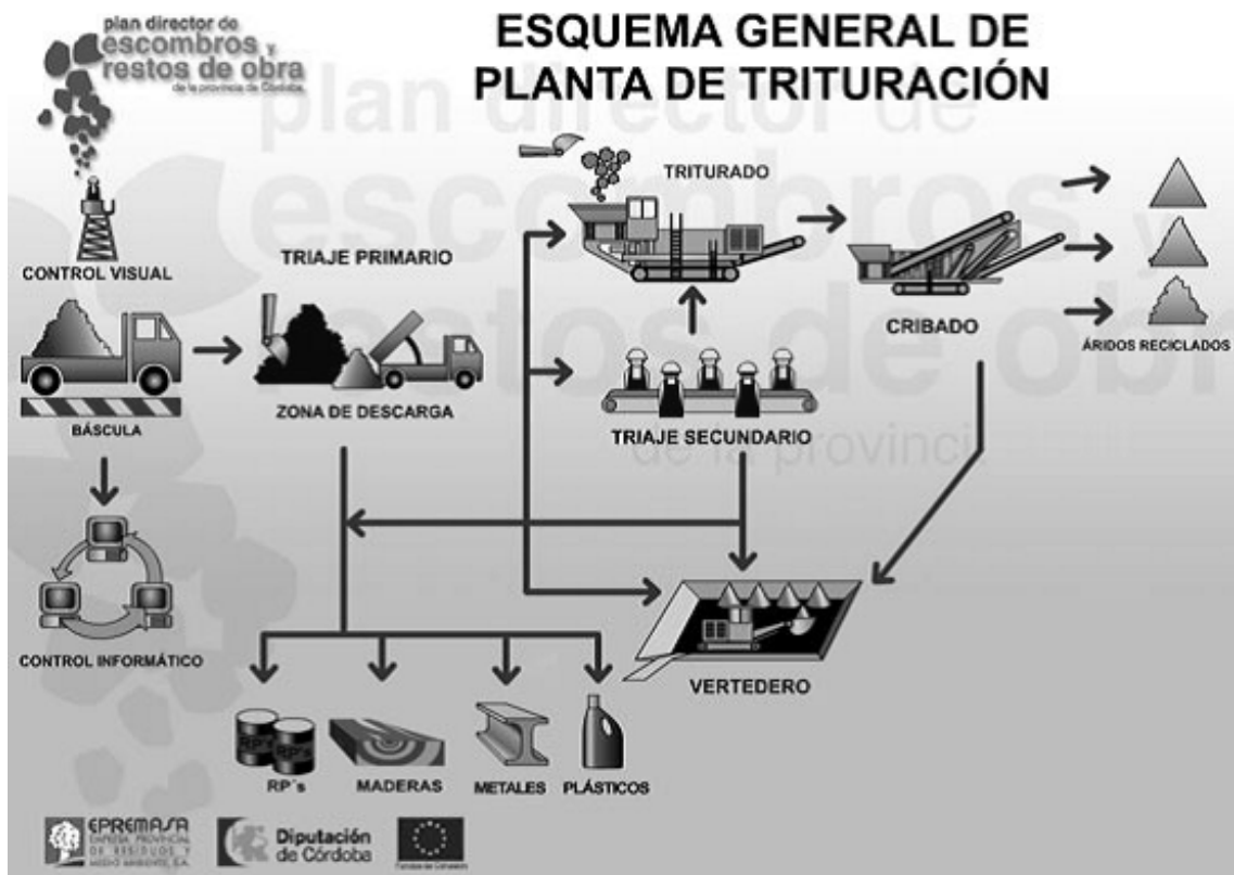
Ilustración 4. Esquema general de procesamiento de los RCD en los Centros de Reciclaje gestionados. Fuente: Plan Director de Escombros y Restos de Obras en al Provincia de Córdoba. Exma. Diputación Provincial de Córdoba. BOP de Córdoba Nº 166 del 30 de Septiembre de 2005.
