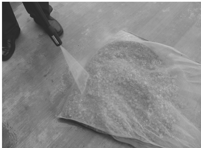
Foto 33, Lavado posterior al triturado para eliminar material fino. Fuente: Revista Materiales de Construcción, 2007, España.
