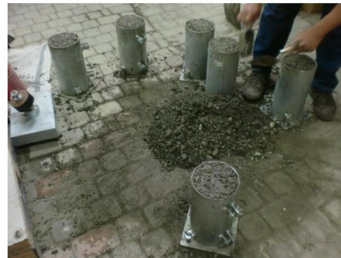
Vaciado de mezcla de hormigón en molde
