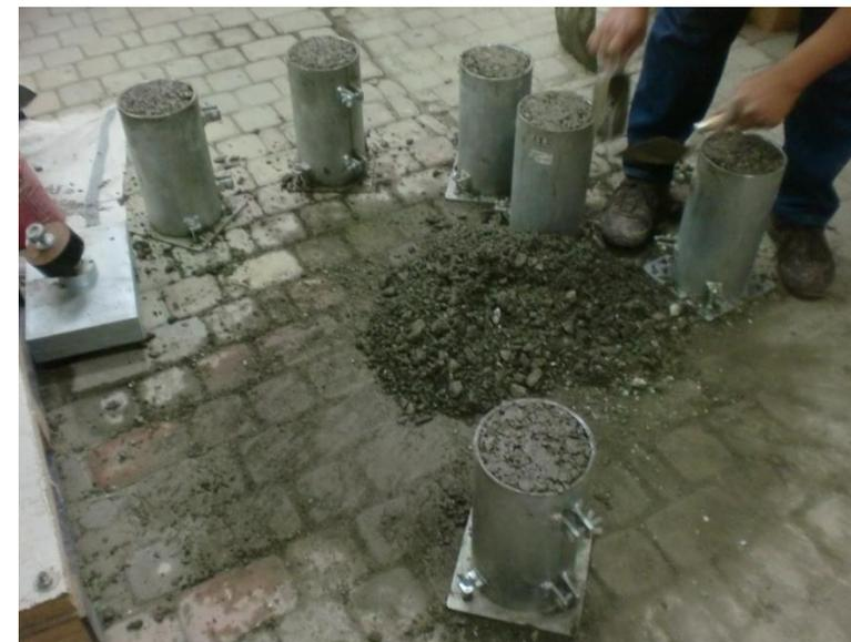
Vaciado de la mezcla dentro de los moldes cilíndricos
