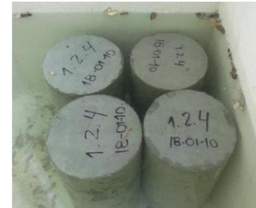
Muestras de hormigón sumergidas en agua
