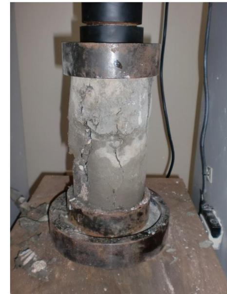
Ensayos de resistencias a la compresión
