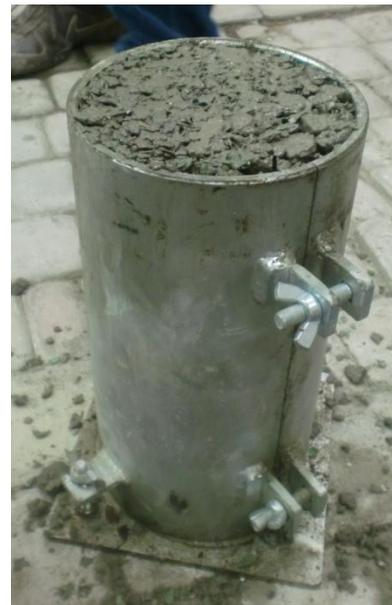
Vaciado de mezcla de hormigón en las probetas cilíndricas
