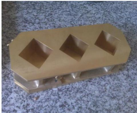
Moldes para vaciar la mezcla de mortero
