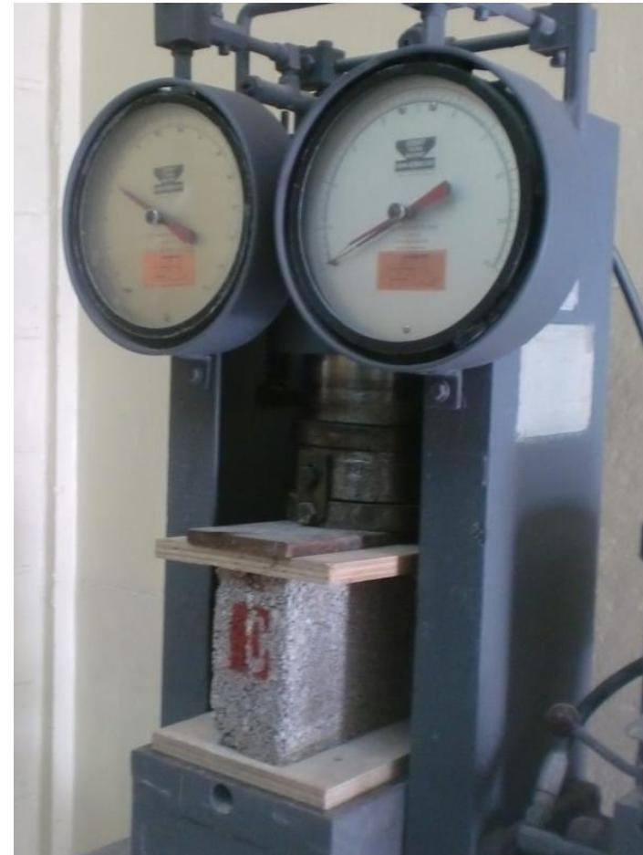
Prueba resistencia a la compresión
