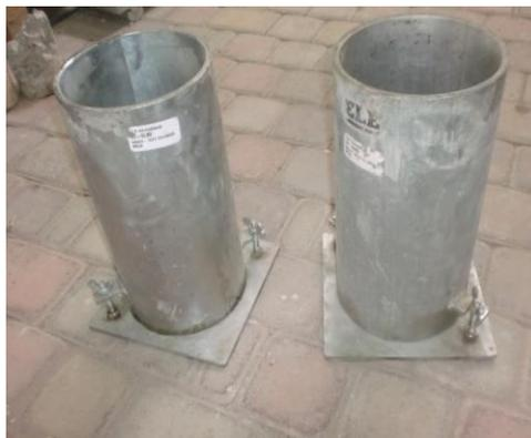
Moldes para vaciar la mezcla de hormigón
