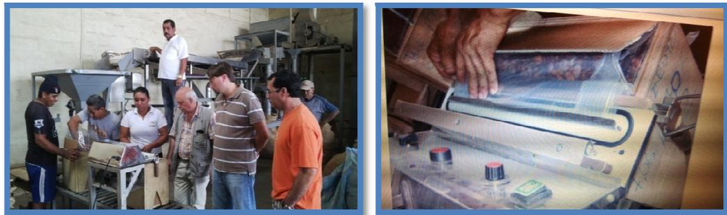
**Figura 14.** Fotos tomadas por el autor donde se demuestra gráficamente el proceso de llenado con cacao en grano, pesado y sellado al vacío del cartón revestido con polipropileno.
