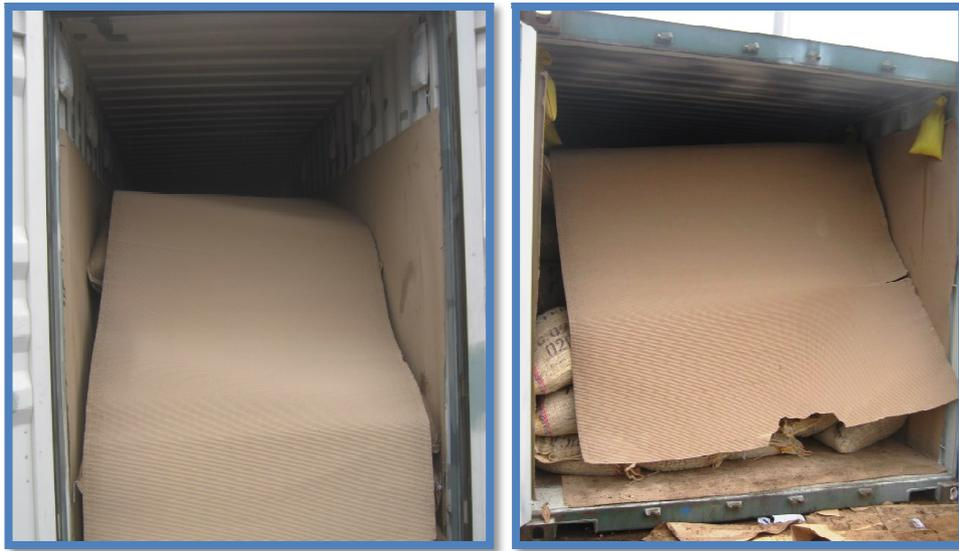
**Figura 6.** Contenedor consolidado con sacos de cacao en grano donde se aprecia el empapelado final y los absorbentes (Dry Bags) utilizados. Elaborado por el autor.
